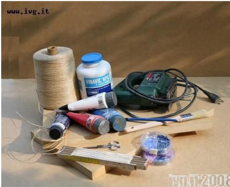
Materiali per la costruzione: mdf spessore 1 cm 120 x 170 mdf spessore 0,6 120x 80, seghetto alternativo, colla vinilica, viti per legno del 16, corda, 1 chiodo, martello, matita.
